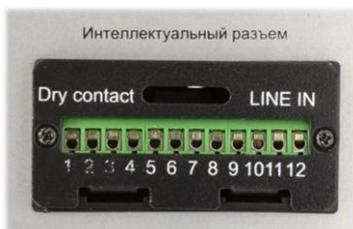
4. Подключите карту к устройству мониторинга при помощи проводов. Оно может отображать состояние ИБП и электросети для удаленного контроля.
