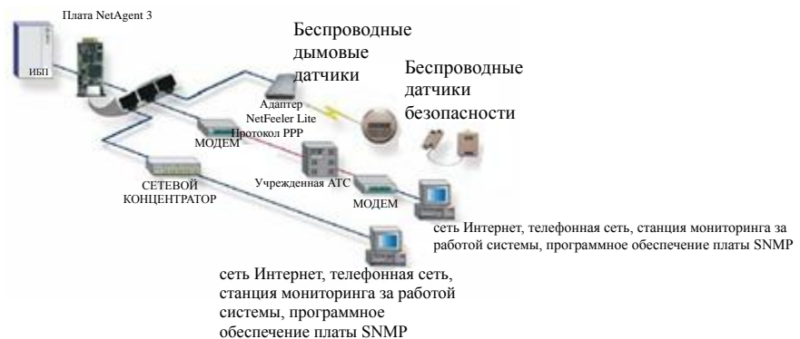
Стандартная топология сетевого управления ИБП.
