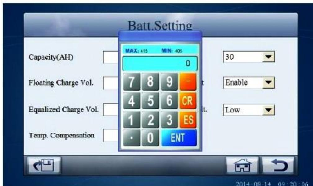
Рис.7-31 Установка параметров «плавающего» заряда
