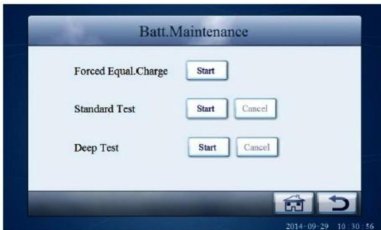
Рис.7-32 Экран обслуживания и проверки батарей
