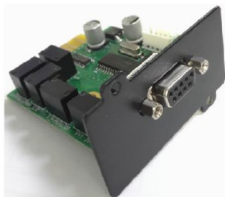
Рисунок 6 – Внешний вид платы AS400
