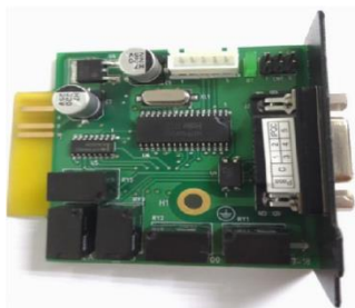
Рисунок 6 – Внешний вид платы AS400
