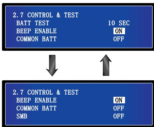
1. **BATT TEST:** Разрешить или не разрешить выполнение теста АКБ. Возможен выбор из трёх вариантов: **ABORT** (прервать), **DEEP** (глубокий) или **10 SEC** (10 секунд).
