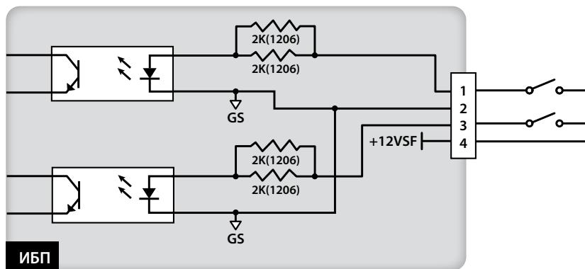
Рис. 5-7. Входы с сухими контактами, конфигурация I
