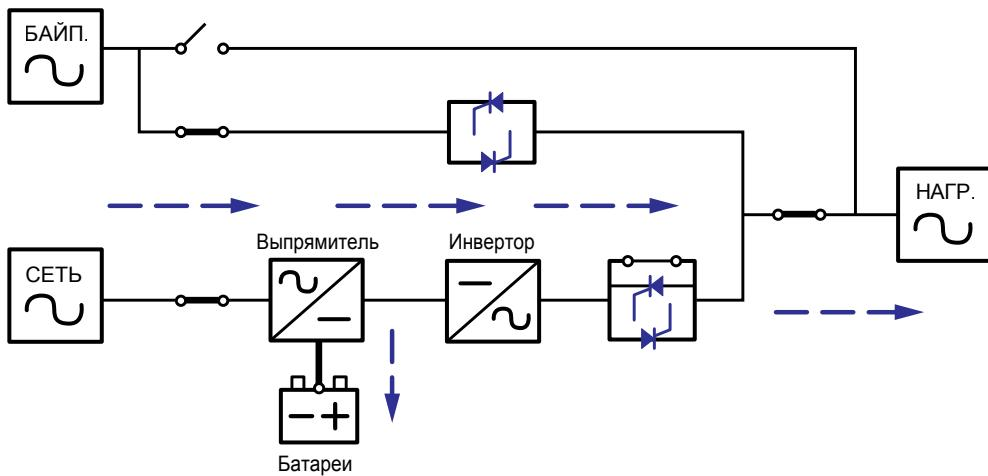
*Рис. 4-1. Передача электроэнергии через ИБП в режиме готовности*
