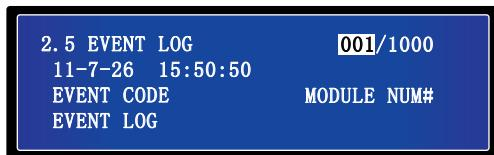
На этом экране показаны номер, дата, время и описание события. Для перехода между записями событий используйте кнопки (**▲**) и (**▼**). Цифровой код означает порядковый номер события. Чем больше номер события, тем позже оно произошло. При превышении максимального числа записей (1000) самые старые записи замещаются новыми по кольцу.
