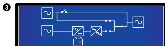
ИБП в режиме байпаса, инвертор отключен. В этом режиме нагрузки не защищены. При исчезновении переменного напряжения на входе байпаса они будут обесточены.
