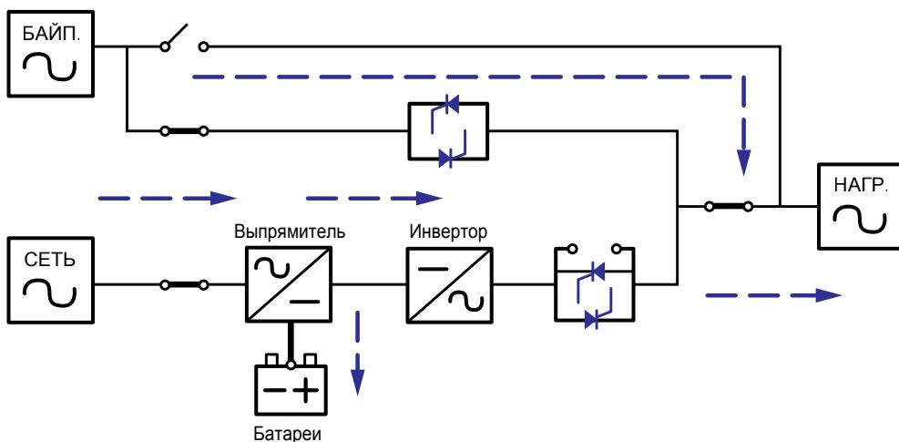
Рис. 4-3. Передача электроэнергии через ИБП в режиме готовности
