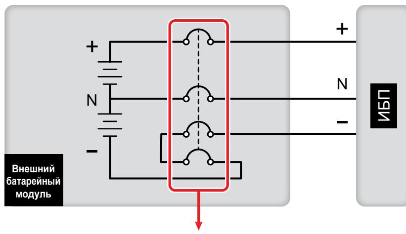
Рис. 6-19. Установка четырехполюсного автоматического выключателя постоянного тока
