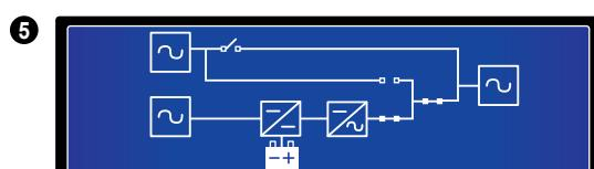
ИБП в автономном режиме.
