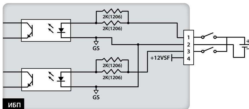
Рис. 5-8. Входы с сухими контактами, конфигурация II
