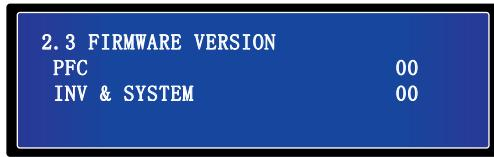
На этом экране показана версия ПО силового блока (PFC), инвертора и системы (INV & SYSTEM).
