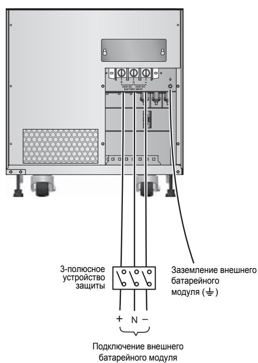
Рис. 6-10. Схема подключения одиночного ИБП 80 кВА в конфигурации с одним входом
