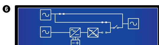
ИБП в режиме ручного байпаса. В режим ручного байпаса ИБП следует переключить перед техническим обслуживанием, чтобы отсоединить его от электросети и батарей. В этом режиме нагрузки не защищены. При исчезновении переменного напряжения на входе байпаса они будут обесточены.
