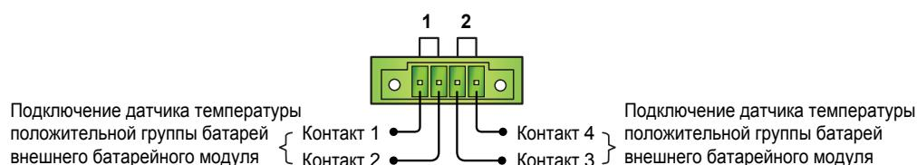
*Рис. 5-5. Порты датчиков температуры внешнего батарейного модуля*
