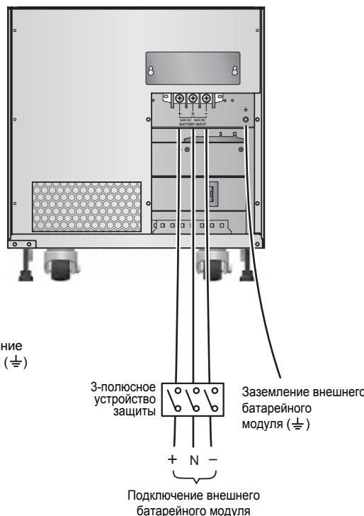
Рис. 6-14. Схема подключения одиночного ИБП 100/120 кВА в конфигурации с двумя входами
