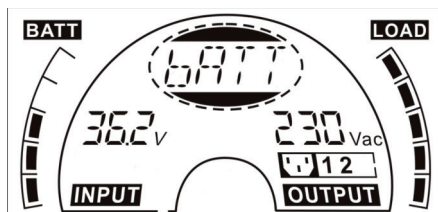
Режим работы от батарей
