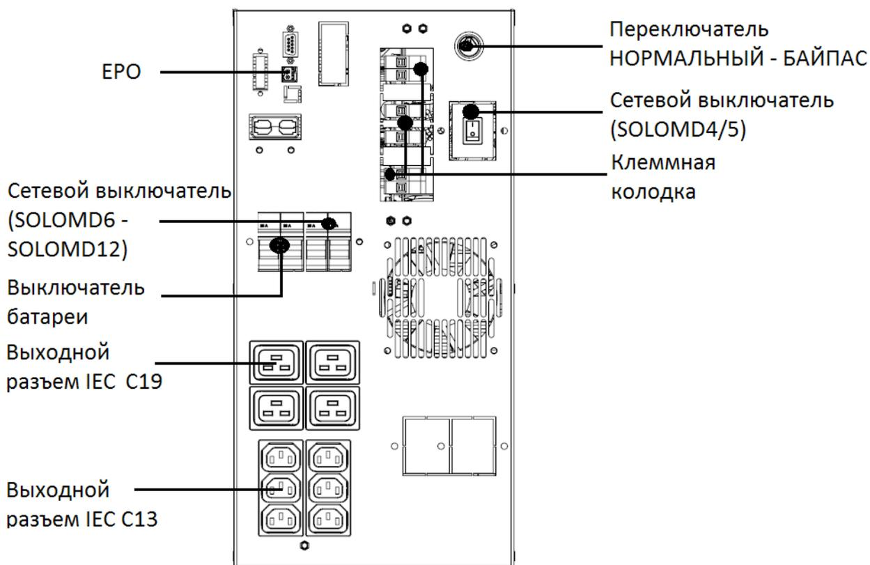
Рисунок 7. Внешний вид ИБП серии Solo MD, вид сзади.
