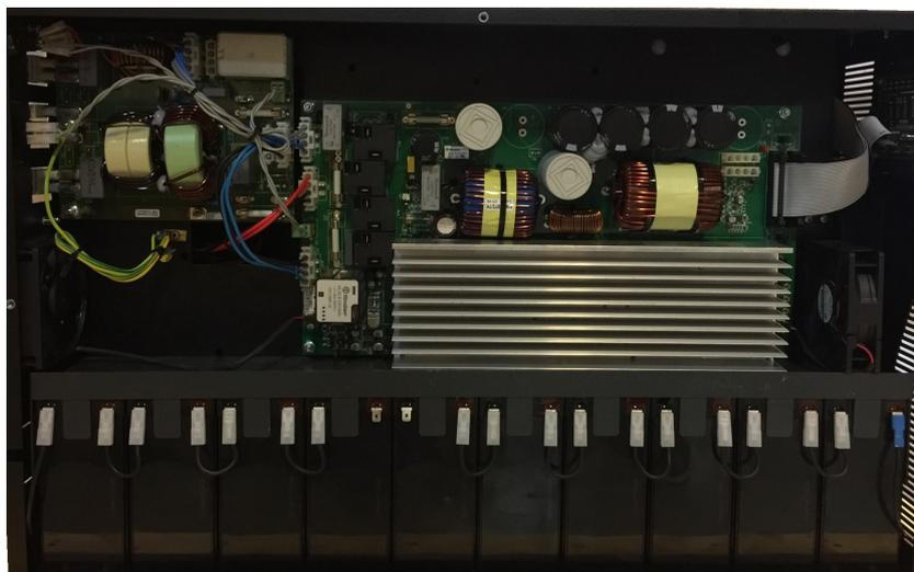
Рисунок 9. Расположение батарей 7/9 Ач Solo MD
