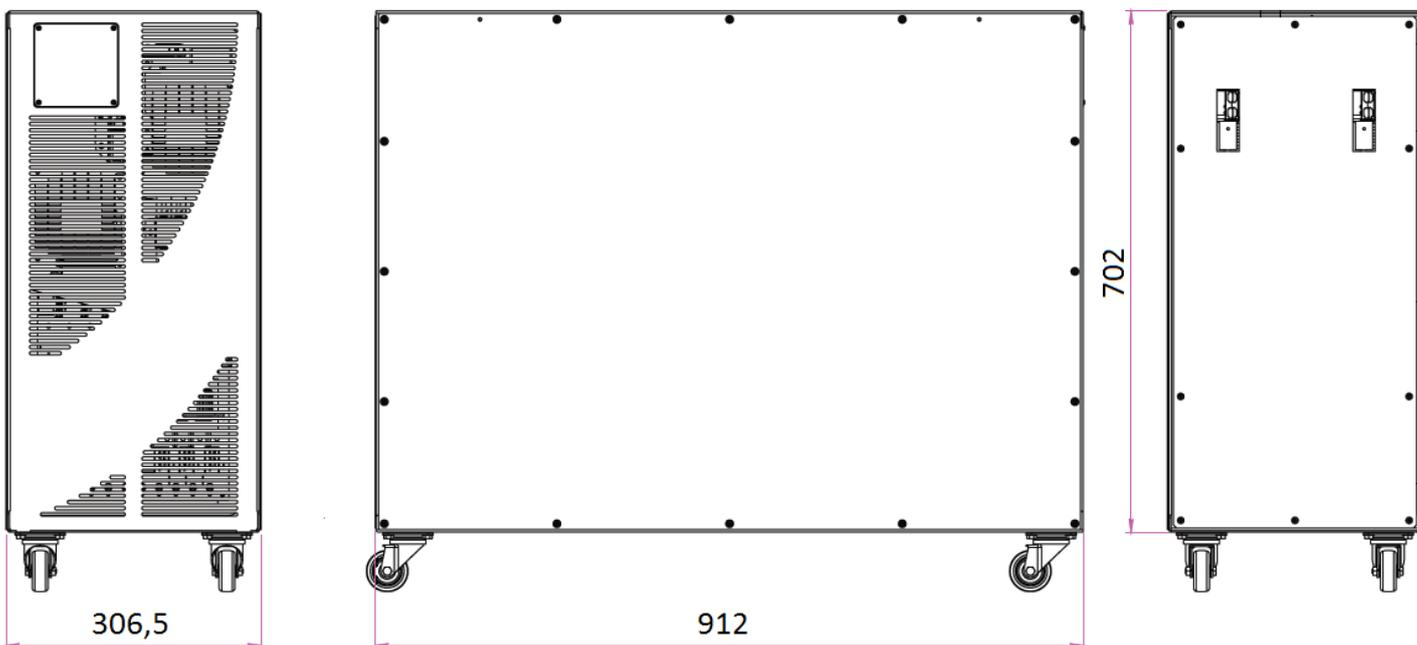
Рисунок 6. Внешний вид батарейного блока серии Solo MMB
