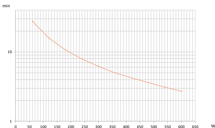
Figura 6. Grafico della durata della batteria INFOPDU1000PL / INFOPDU1000LCD
