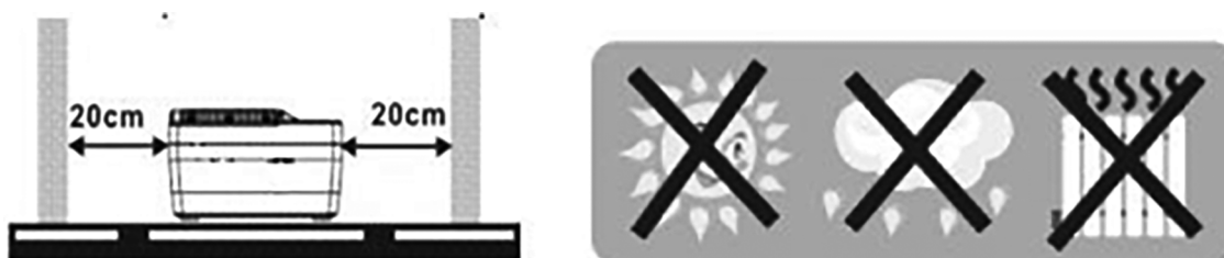
Figure 1. Posizionamento dell' UPS
