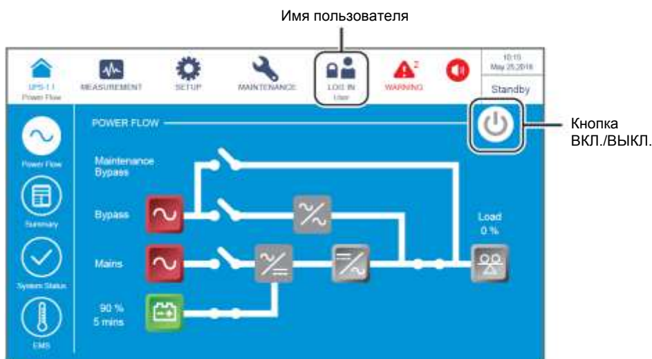
Рисунок 6-7: Главный экран: расположение кнопок имени пользователя и ВКЛ./ВЫКЛ.
