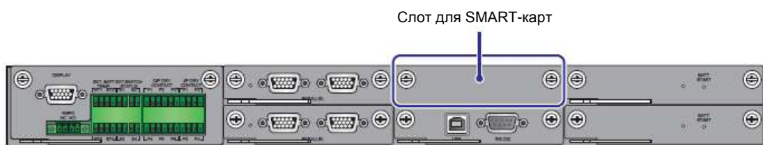
Рисунок 4-13: Расположение слота для SMART-карт
