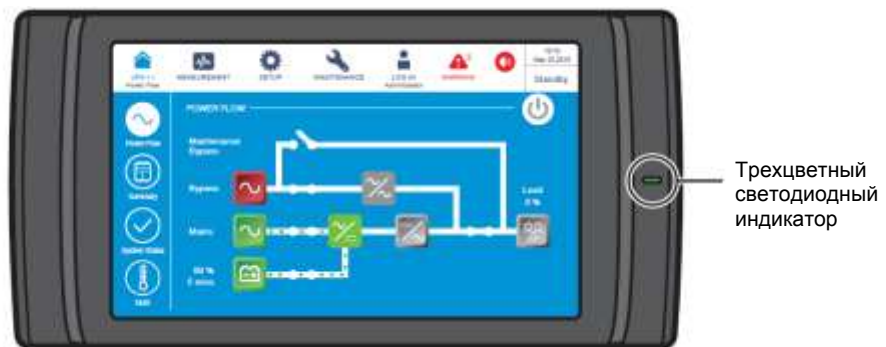
Рисунок 2-11: Расположение трехцветного светодиодного индикатора
