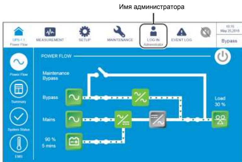
Рисунок 6-55: Экран байпасного режима и имя администратора
