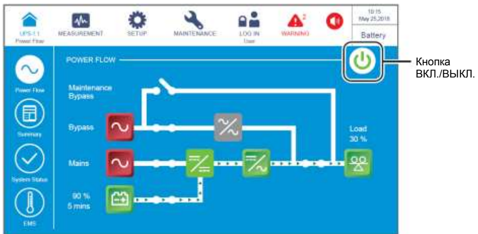
Рисунок 6-48: Экран батарейного режима и кнопка ВКЛ./ВЫКЛ.
