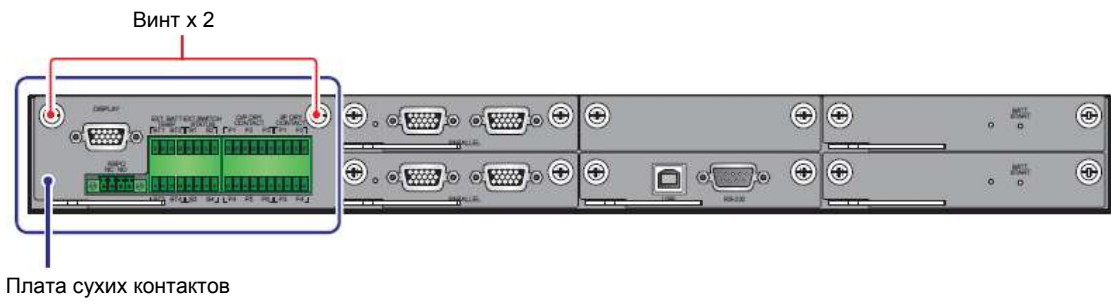
Рисунок 4-5: Расположение платы сухих контактов
