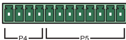
Рис. 4-7. Сухие контакты батареи
