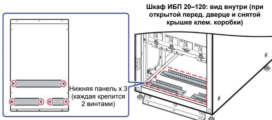
Рисунок 5-14: расположение нижних панелей
