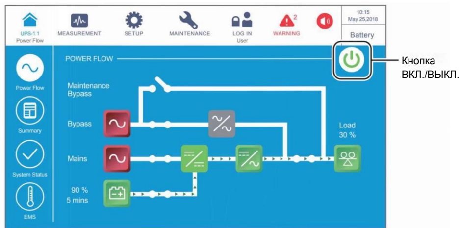
(Рисунок 6-48: Экран режима работы от батареи и расположение кнопки ВКЛ./ВЫКЛ.)
