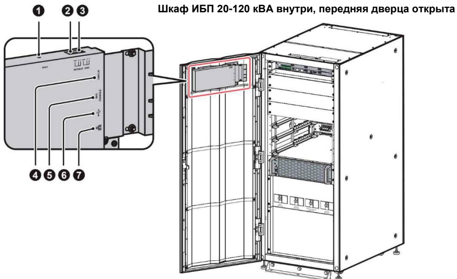
Рисунок 4-25: интерфейсы связи на обратной стороне сенсорной панели
