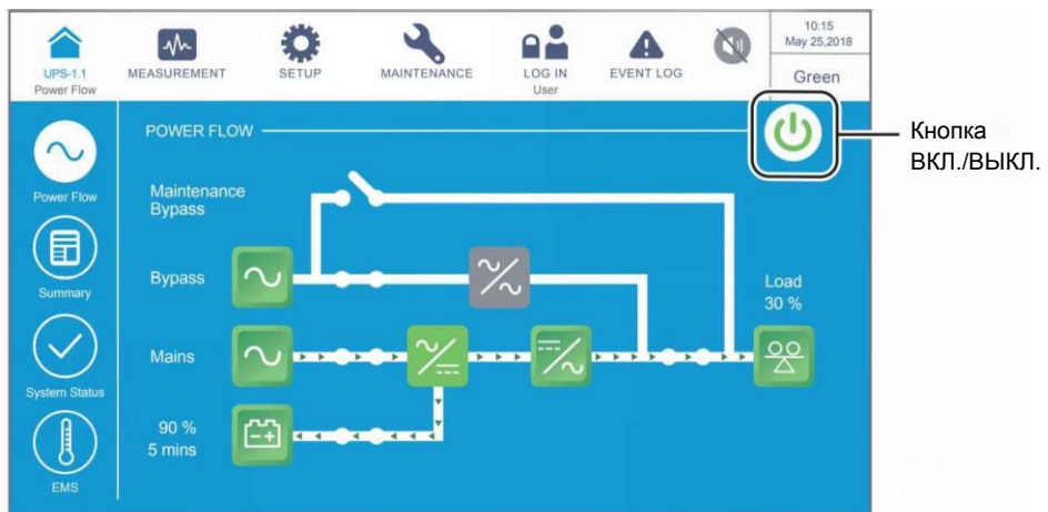
(Рисунок 6-62: Экран экологического режима и расположение кнопки ВКЛ./ ВЫКЛ.)
