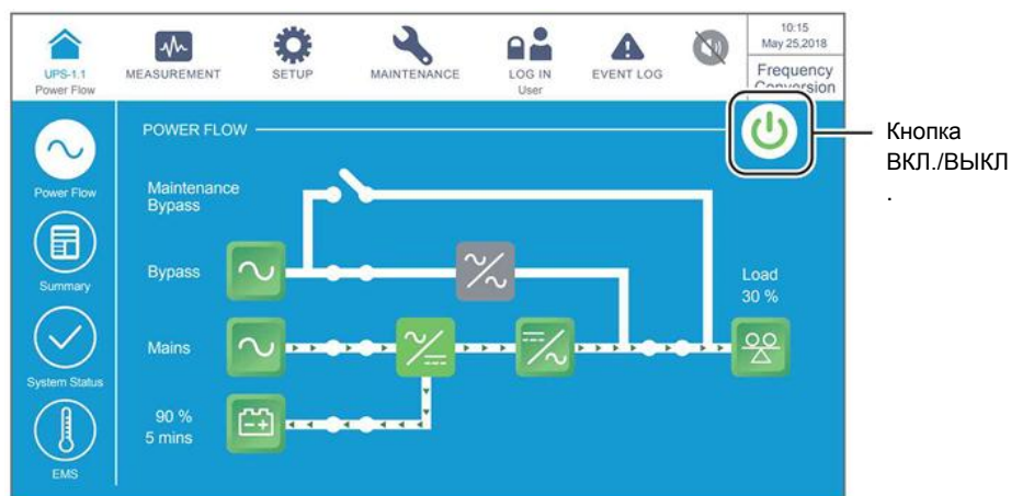
(Рисунок 6-57: Экран режима преобразования частоты и кнопка ВКЛ./ВЫКЛ.)
