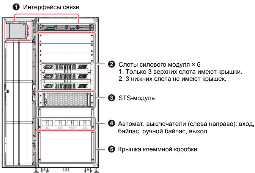
Рисунок 2-4: Шкафы ИБП внутри, передняя дверца открыта
