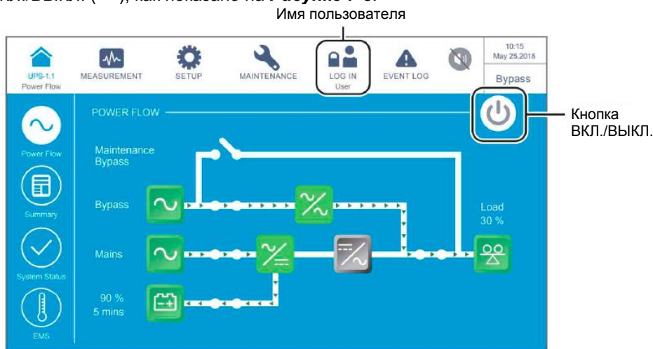
(Рисунок 7-5: Главный экран: расположение кнопок имени пользователя и ВКЛ./ВЫКЛ.)
