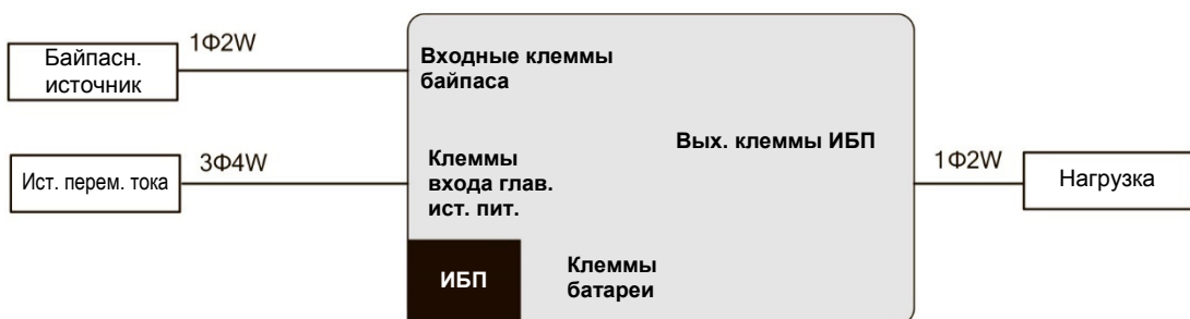
Рисунок 7-6. Схема проводки ИБП. Однофазный выход и вход от двух источников питания
