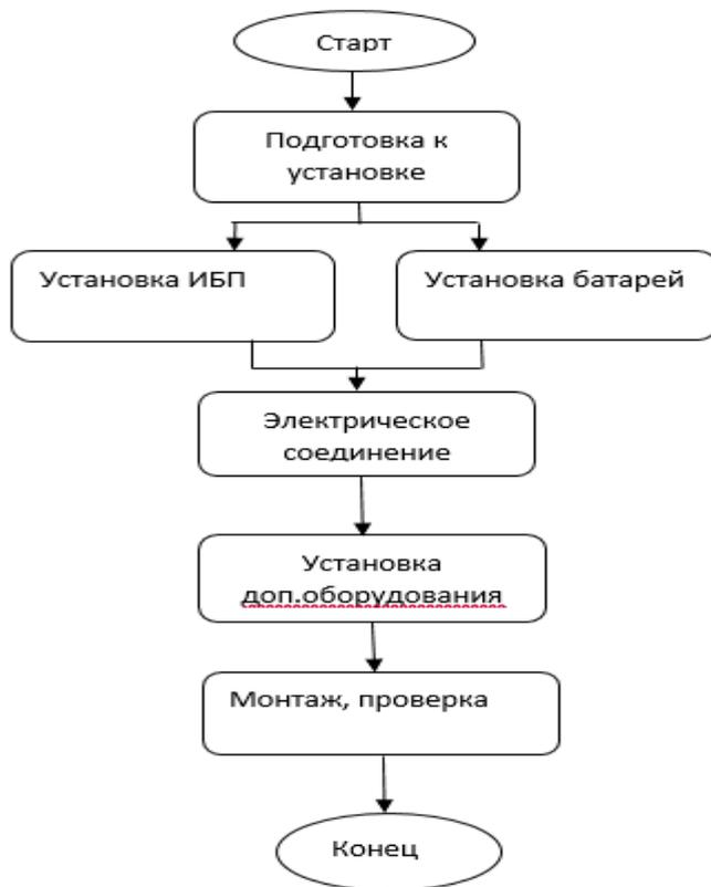
Рис 3.1 Процесс установки
