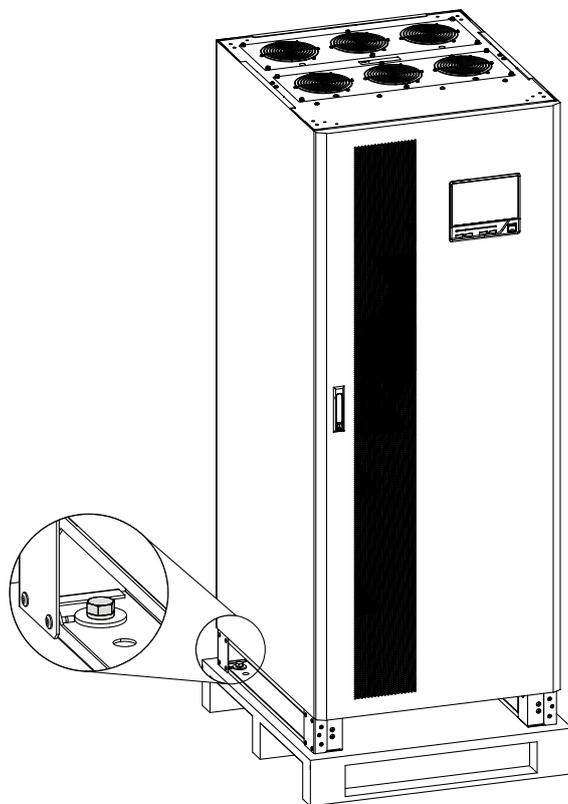
Рис 3.7 Крепёжные болты для ИБП FR-UK(/B)33(100-160)
