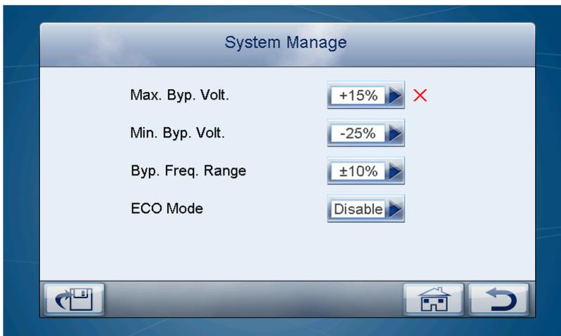
Рис 4.25 Установка параметров прошла неудачно
