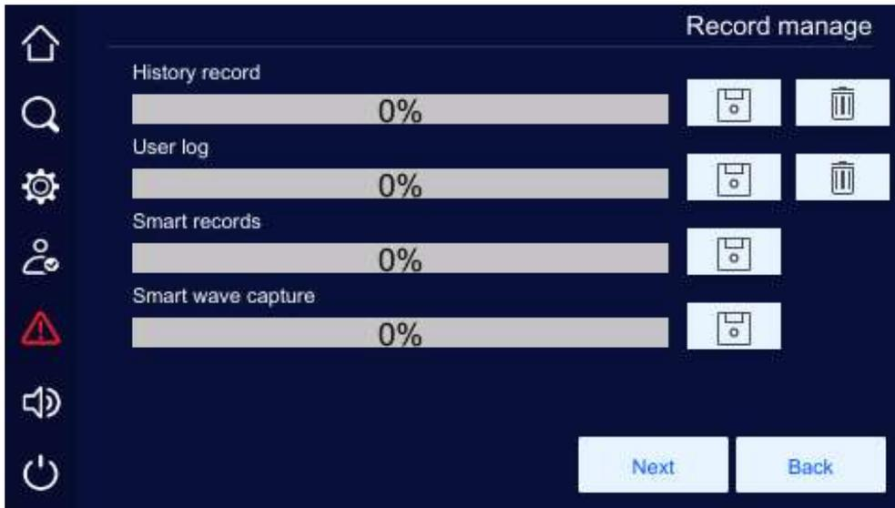
Рис4-29 Страница записи информации с ИБП на носитель
