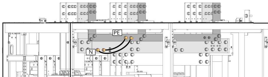
Figure A-1 Short-circuiting the input N and PE
