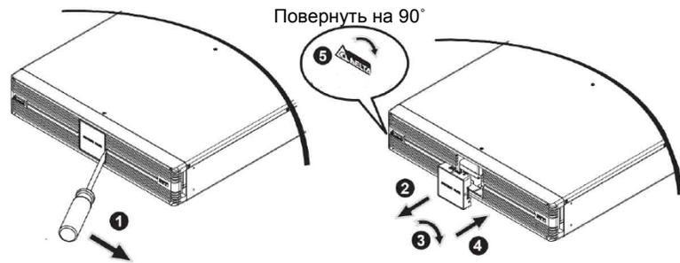
**Рисунок 5. Поворот панели управления внешнего батарейного блока Delta и таблички с логотипом Delta**
