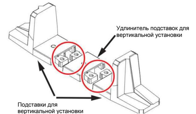
Рисунок 4. Сборка удлинителей и подставок для вертикальной установки ИБП
