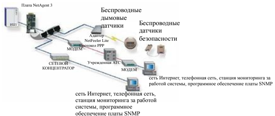
Стандартная топология сетевого управления ИБП.
