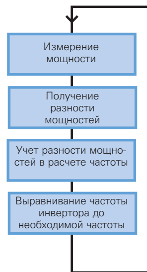
Рис. 4. При использовании алгоритма Hot Sync угол фазы инвертора регулируется выходной мощностью и коэффициентом ее изменения.
