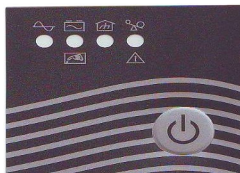
Рис. 3.3-1 Лицевая панели ИБП серии Intelligent II RM1U
