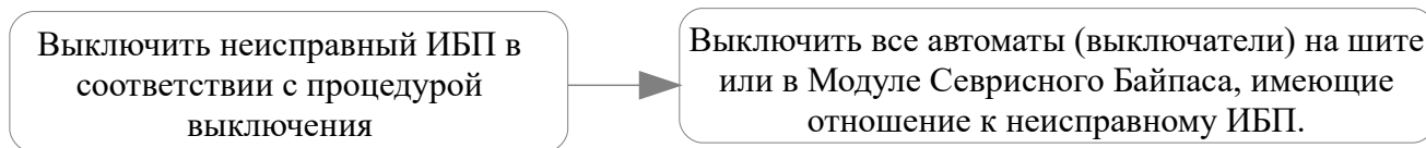
Рис. 5-1 Исключение неисправного ИБП из параллельной системы
