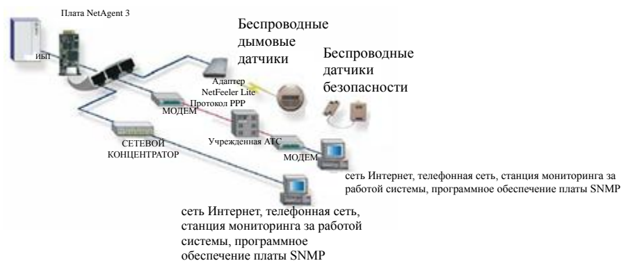
Стандартная топология сетевого управления ИБП
