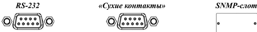
Для осуществления мониторинга и управления ИБП подключите соответствующие кабели к портам RS-232, «Сухие контакты» или к SNMP-адаптеру.
