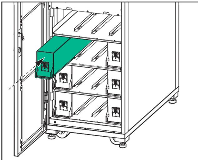
3. Опустите ручку каждого модуля батареи и закрепите с помощью расположенных спереди винтов.
