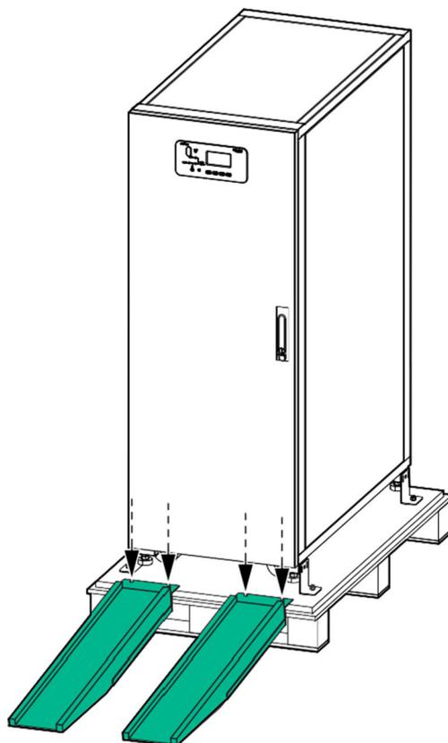
4. Ослабьте болты и снимите транспортировочные кронштейны. Утилизируйте транспортировочные кронштейны.
