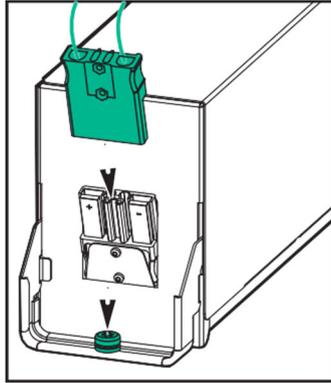
4. Снимите термоусадочные трубки с клемм питания и подключите клеммы к батареям.
